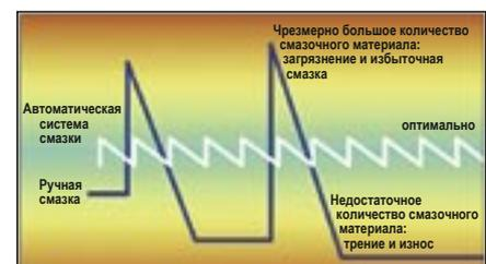
При сравнении с ручной смазкой система централизованной и/или автоматической смазки обеспечивает целый ряд преимуществ.
