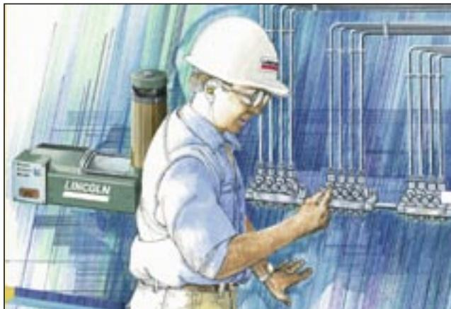
**Автоматическая система централизованной смазки**
