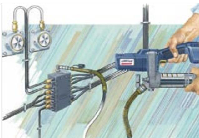
**Централизованная система смазки**
