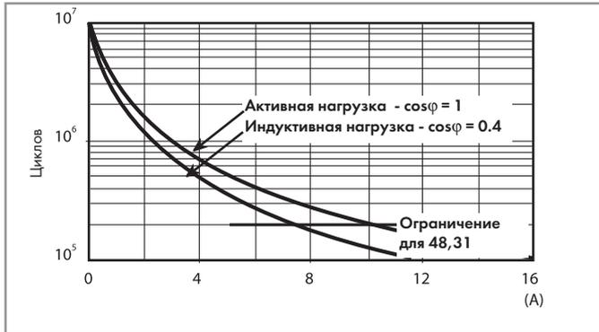
**F 48 - Электрическая долговечность (АС) при ном. нагрузке**
