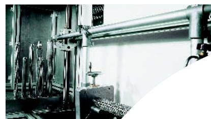
Конечный контроль на стенде для проведения Bubble-Point тестов. На нашем предприятии производятся фильтровальные свечи только безупречного качества.
