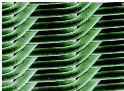
Многоразово регенерируемый фильтроэлемент.
