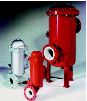
Обширная производственная программа линейных фильтров для расходов до 25000 л/мин. Материал корпуса: чугун с шаровидным графитом EN JS 1030 или нормальная сталь 1.0038 или полностью из нержавеющей стали. Фланцевое присоединение начиная с размера DN50. Давление в зависимости от типоразмера PN 25 или PN 16 бар. Фильтроэлементы соответствуют исполнению PRFLD.
