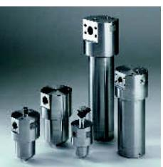
Сверхпрочный напорный фильтр из нержавеющей стали для использования с агрессивными средами и в экстремальных условиях эксплуатации до 400 бар и 400 °C. Фильтрующие материалы: проволочная сетка, Chemicron®, металловолокно, Betamicron®, стекловолокно. Возможности присоединения: цилиндрическая трубная резьба G 3/4", 1 1/4", 1 1/2".
