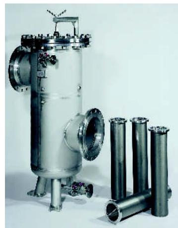
Сетчатые фильтры находят свое применение в качестве фильтра грубой очистки или предварительного сепаратора. Прохождение через фильтроэлемент из нержавеющей стали идет в противоположность линейному фильтру PRFL и PRFLD изнутри наружу. Отсорбируемые твердые частицы остаются в сетчатом фильтре и легко могут быть удалены. Материал: нормальная сталь 1.0038 или нержавеющая сталь 1.4571.
