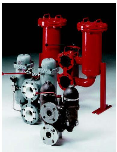
Чтобы избежать остановок в работе во время замены элементов, применяются переключаемые фильтры, при этом один корпус фильтрует, а другой находится в резерве. Переключение осуществляется с помощью шарового крана или запорной заслонкой с маховиком. Особая форма запорного механизма применяется, чтобы обеспечить одновременное переключение обеих частей. Корпус фильтра может оснащаться щелевыми трубами, или патронами с фильтрующим слоем из проволочной сетки или Betamicron® синтетического волокна.
