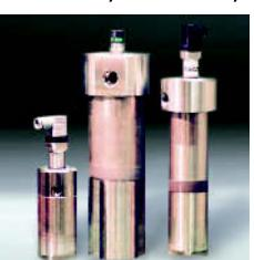
Эти высоконапорные фильтры из нержавеющей стали по своей конструкции аналогичны фильтрам EDFA. В распоряжении имеются три варианта на давления 450, 700 и 1000 бар. Максимальная рабочая температура составляет 100 °C. Фильтрующие материалы: проволочная сетка, Chemicron®, металловолокно, Betamicron®, стекловолокно. Возможности присоединения: резьба типа BSP или NPT G 1/4", 3/8", 1/2", 3/4", 1", 1 1/4", 1 1/2"; SAE4 до SAE 24.
