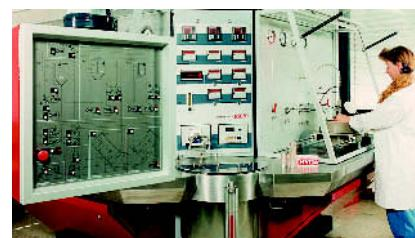
Унифицированные методы тестирования для наших фильтроэлементов обеспечивают высокую постоянную производительность. На нашем стенде для проведения Multi-Pass-теста проверяется степень сепарации и грязеемкость.
