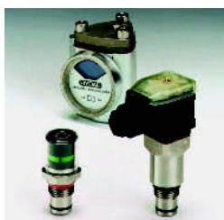
Для контроля загрязнения фильтроэлементов мы предлагаем ко всем типам линейных фильтров различные визуальные и визуально-электрические индикаторы загрязненности. Все индикаторы работают по принципу измерения перепада давления и возвращения в исходное положение.
