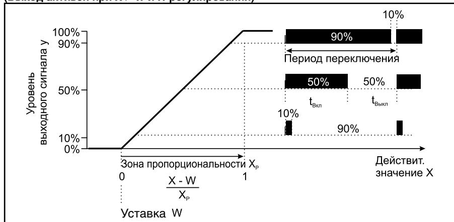
Если действительное значение превышает заданное значение, П-регулятор регулирует пропорционально величине отклонения. При превышении зоны пропорциональности регулятор работает с уровнем выходного сигнала 100 %.
