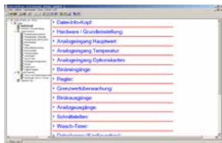
Setup-интерфейс интегрирован в прибор JUMO dTRANS CR02 по умолчанию. С помощью setup-интерфейса, setup-программы(принадлежности) и setup-кабеля (принадлежности) можно проводить настройку прибора.
