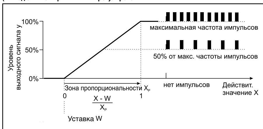
Если действительное значение превышает заданное значение, П-регулятор регулирует пропорционально величине отклонения. При превышении зоны пропорциональности регулятор работает с уровнем выходного сигнала 100 % (максимальная частота переключения).
