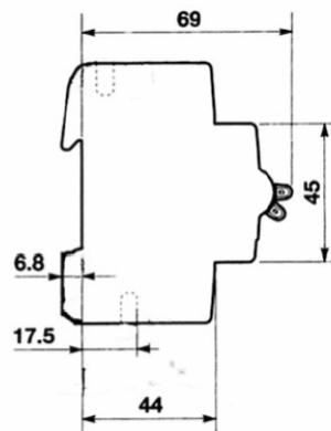
**Автоматические выключатели** - стандарт IEC/EN 60898, ном.напряжение Ue=230/400В, ном.отключающая способность I<sub>сп</sub>=4500А, время-токовая характеристика С (5I<sub>n</sub>≤I<sub>m</sub>≤10I<sub>n</sub>), клеммы верх/низ 25мм<sup>2</sup>, затягивающее усилие 2,5Нм, электр.износостойкость 10000 циклов, мех.износостойкость 20000 циклов, температура окружающей среды -25...+55°С, подключение питающего напряжения – сверху или снизу, монтажное положение – любое, вес одного полюса 125грам.
