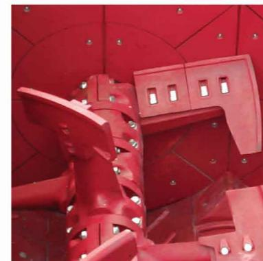
Смесительные лопатки, выполненные из HARDOX 500HB толщиной 20 мм, высокопрочные при сопротивлении на удар. Рычаги смещивания, выполненные из чугуна с шаровидным графитом, присоединены болтами к валам.
