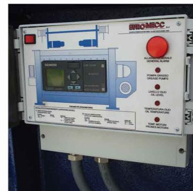
Синоптический пульт с PLC для идентификации неправильной работы, управление аварийными сигнализаторами и регистрация отклонений от нормы.
