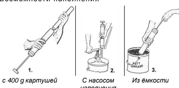
Следящий поршень Lincoln смазочных шприцов 1142 и 1147 устанавливается при применении 400 г стандартных картушей, а 1151 для наполнения из ёмкости.
