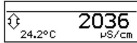
В этом режиме цифровое значение дополняется символом, указывающим направление изменения и скорость изменения измеряемой величины. Это может быть очень полезным при проведении оптимизации регулятора.
