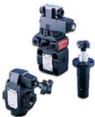
Клапаны контроля давления могут выполнять функции перепускного, редукционного, разгрузочного клапана или клапана последовательности. Они выпускаются в исполнениях для трубного монтажа и для установки на монтажных плитах, и способны выполнять разнообразные функции, включая дистанционное регулирование, поддержание нескольких уровней давления и сливы в гидробак.
