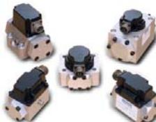
Эти двухступенчатые четырехлинейные клапаны с распределительным элементом типа «сопло-заслонка» осуществляют регулирование по замкнутому контуру, обеспечивая высокую точность позиционирования, воспроизводимую скорость и предсказуемое усилие (при регулировании крутящего момента). Серия Vickers SX4 отличается от серии SM4 более широкой частотной характеристикой, т.е. пригодны для систем обратной связи с более строгими требованиями.
