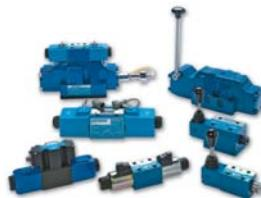
Направляющие трёх- или четырёхлинейные распределители со стандартными присоединительными частями широко применяются в стационарных и передвижных машинах. Их основная функция – подача рабочей жидкости в цилиндр и переключение направления вращения гидромотора. Такие распределители могут быть оснащены электромагнитным, гидравлическим, пневматическим или механическим приводом управления.
