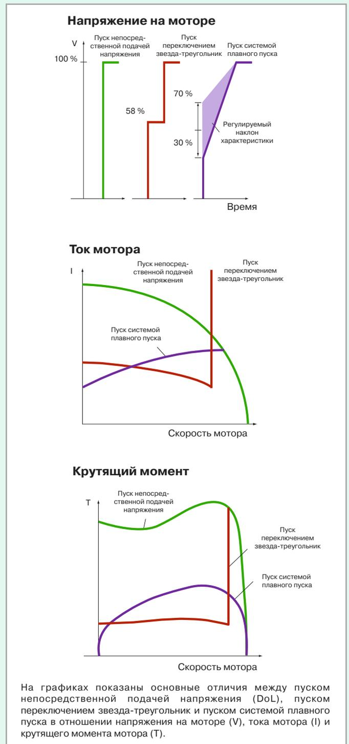
На графиках показаны основные отличия между пуском непосредственной подачей напряжения (DoL), пуском переключением звезда-треугольник и пуском системой плавного пуска в отношении напряжения на моторе (V), тока мотора (I) и крутящего момента мотора (T).
